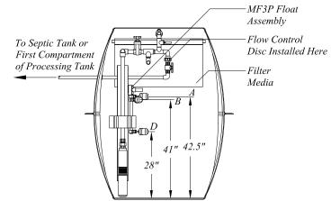
Recirc. Blend Tank End View *Scale:* 1'' = 3'-0''
